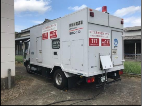
移動電源車による通信ビル機能の維持
